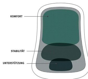
Das von uns entwickelte Duo Membranmaterial des Lino Stuhls besitzt drei atmungsaktive Zonen mit unterschiedlichen Spannungen zur Abstützung von Brust-, Kreuzbein- und Lendenbereich.
